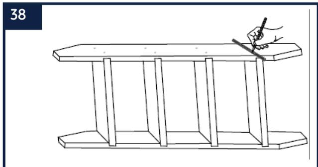
38 Utilisez une règle et un crayon de papier pour indiquer l'emplacement des trous qui permettront de fixer les marches.
