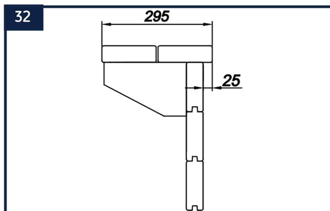
Positionnez correctement les margelles de votre piscine en respectant les côtes indiquées sur le schéma ci-dessus. Veillez à laisser un espace de 5 mm entre les margelles intérieures et extérieures.
