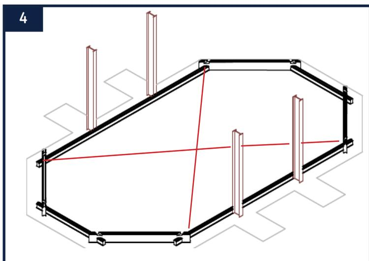
Avant de passer à l'étape suivante, vérifiez les dimensions de vos diagonales à l'aide du schéma page 21.
