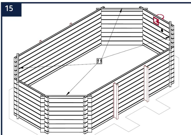
Positionnez ensuite les demi madrier supérieurs (11) aux endroits indiqués sur le schéma ci-dessus. En cas de besoin, utilisez la cale en bois pour les encaster correctement.
