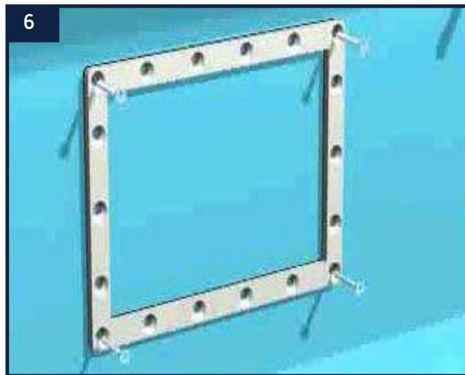
6 Positionnez la bride en respectant son sens (répérez sur la face interne les réservations pour les vis à tête rondes utilisées pour le premier joint) et vissez-la en utilisant les 10 vis inox à tête plate.
