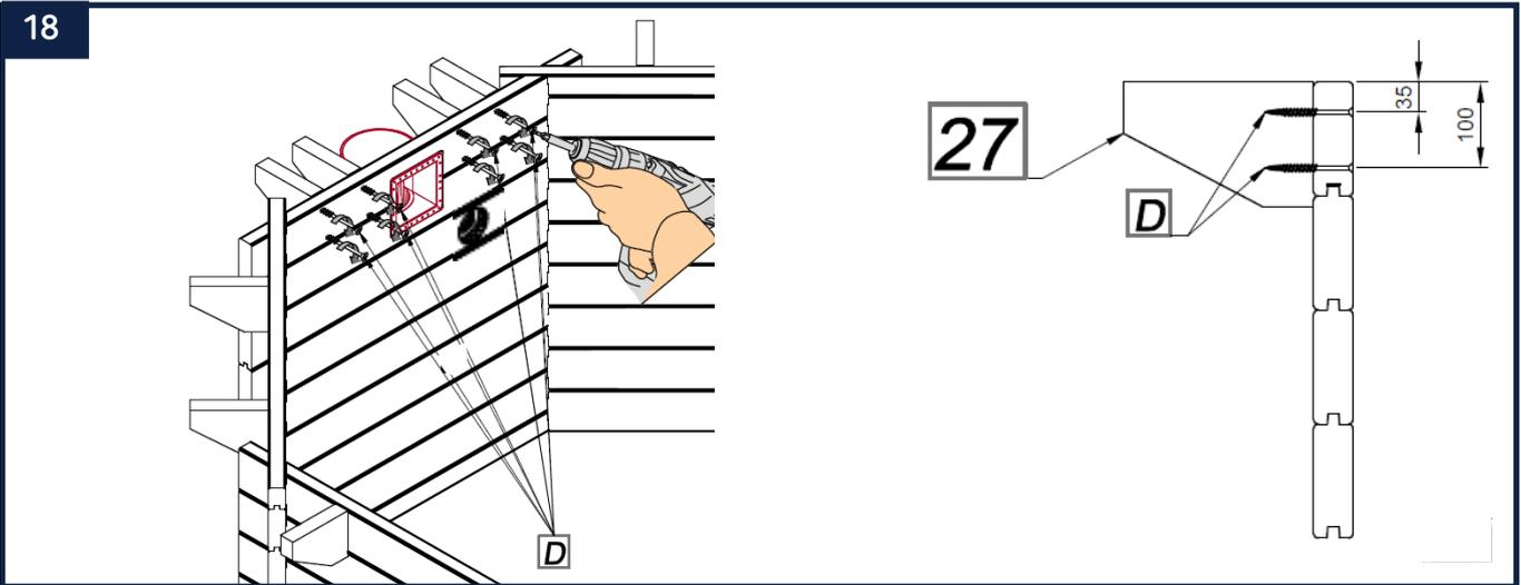
Fixez à l'extérieur de votre piscine, 18 supports de margelle (27) aux endroits mentionnés sur le schéma page 26. Pour cela, fixez chaque support à l'aide de 2 vis 5 x 100 mm (D) en suivant avec attention les côtes indiquées sur le schéma ci-dessus. Pour vous faciliter la tâche, utilisez une visseuse équipée d'un embout PZ2.
