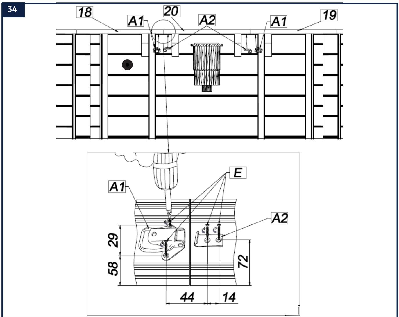
Fixez, à l'aide des vis 3 x 35 mm (E), les sauterelles verrouillables (A1) sous les margelles des skimmer (19 -20) en respectant les côtes indiquées ci-dessus. Fixez ensuite les boucles de margelles (A2) sous la margelle amovible (20) à l'aide des vis 3 x 35 mm (E).
