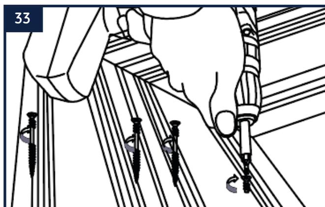
Fixez les margelles à l'aide des vis 5.3 x 80 mm (H) en commençant par les margelles intérieures. Celles-ci sont fixées sur l'ossature bois et sur le croisement des parois de la piscine. Fixez ensuite les margelles extérieures sur les supports de margelles ou sur les renforts horizontaux lorsqu'il s'agit de grandes longueurs ou de la paroi de l'escalier.
