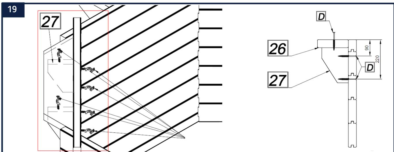
Fixez ensuite les 2 derniers supports de margelles (27) à l'aide de 2 vis 5 x 100 mm (D) en suivant précisément les indications présentées ci-dessus. Une fois cette action réalisée, fixez à l'aide d'une vis 5 x 100 mm (D) le renfort d'escalier (26) au support de margelle (27). Répétez cette action pour le second support. Pour vous faciliter la tâche, utilisez une visseuse équipée d'un embout PZ2.
