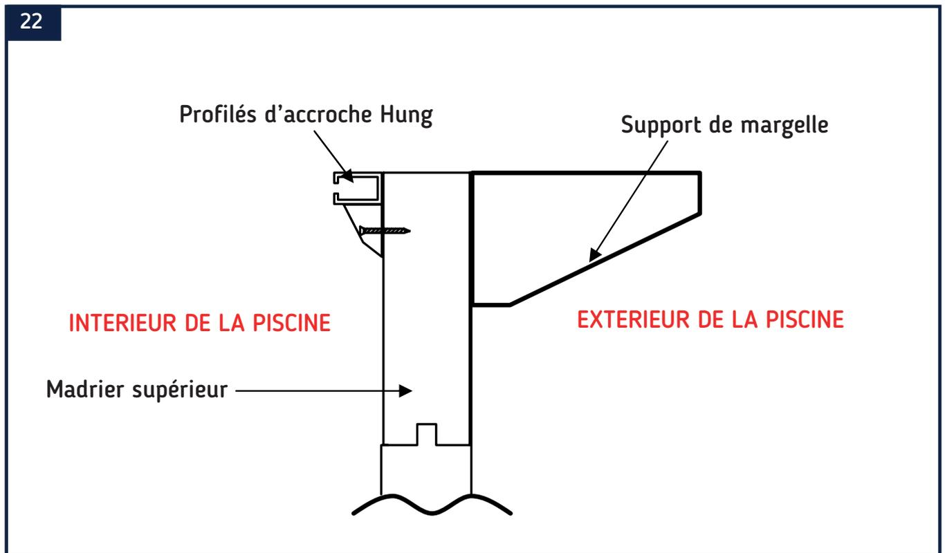
Les profilés de PVC blanc Hung seront fixés en haut de la paroi, à l'intérieur du bassin, à l'aide des vis 3 x 35 mm (E). Coupez les profilés à la mesure des côtés intérieurs de la piscine à l'aide d'une scie à métaux. Gardez les chutes : elles vous serviront à terminer le dernier côté. Les vis doivent être espacées d'environ 30 cm. Attention, le haut du profilé en PVC doit être positionné à la limite supérieure de l'ossature (voir schéma ci-dessus).
