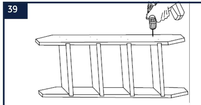
39 Une fois les trous indiqués, percez-les à l'aide d'une perceuse équipé d'un foret de 3 mm.
